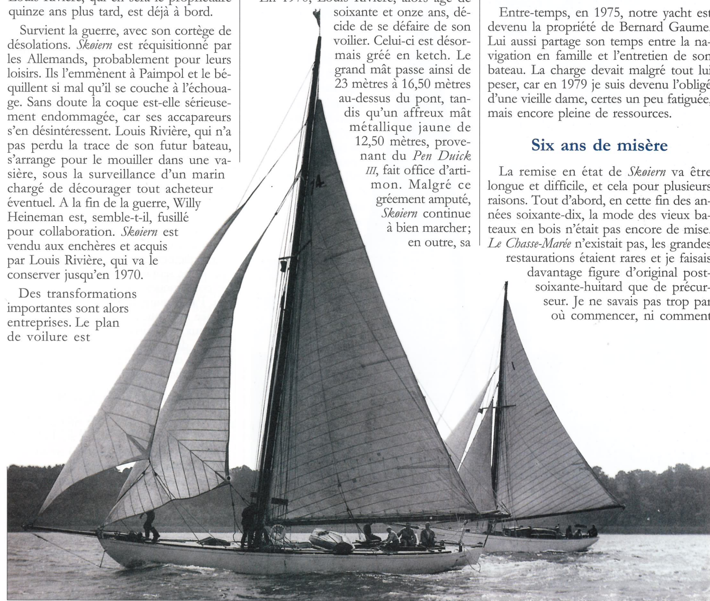
En 1936, lorsque Beken réalise ce beau portrait de Skoiern courant dans le Solent, le yacht est basé au Havre et participe aux régates d'outre-Manche. Remarquer le tangon mâté, l'annexe saisie en travers du pont dépourvu de superstructures, le ris pris, la bastaque mollie sous le vent et la double balancine.
